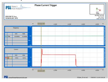
eine Grafik (und ein Excel®-File) mit detaillierten Stromsignaturen vor und nach dem Anlauf. Ein hoher Einschaltstrom zeigt Probleme beim Motoranlauf, eine mögliche Ursache könnte Lagerverschleiß sein, der überprüft werden muss. Wenn die Signatur zeigt, dass der Strom einige Sekunden länger durch den Motor fließt als gewöhnlich, entwickelt sich möglicherweise ein mechanischer Schaden. So können Sie potenzielle Ausfälle vorhersagen bevor diese auftreten.
